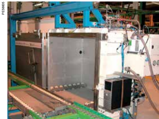
SF6 leak test
